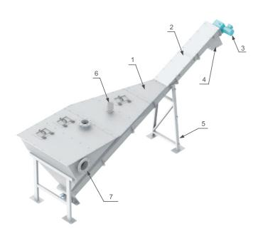
Сепаратор песка Hydrig SPU используются для предварительной очистки входящего стока от песка. Сепаратор песка целесообразно использовать на станциях очистки воды до 2000 м3/сут., там, где есть необходимость регулярной выгрузки песка из очистных сооружений, исключая при этом использование полей фильтрации и специальных песковых насосов.
